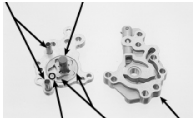
MARCA GRAVADA ROTORES ESPAÇADOR DA BOMBA BASE DA BOMBA
